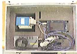
Figure 1 機体基礎特性収集可搬型簡易装置
