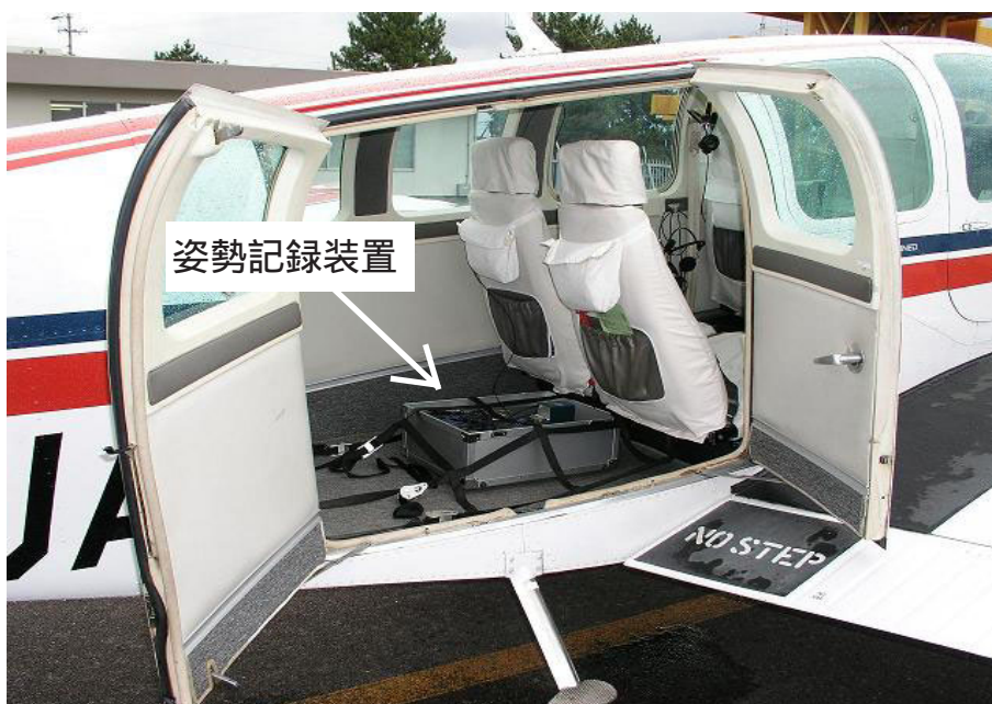
図2 姿勢記録装置の訓練機内への設置の様子
